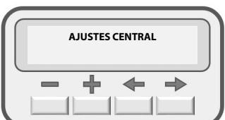
O ajuste de fábrica sai como permitido para bloquear pressione e solte a tecla (+) para desbloquear pressione e solte a tecla (-). Esta função proporciona uma maior segurança diminuindo a chance de uma programação indevida.
