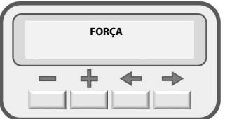
A força sai de fabrica no nível máximo, para diminuir basta pressionar a tecla (-) ate o nível desejado, para aumentar basta pressionar a tecla (+).
