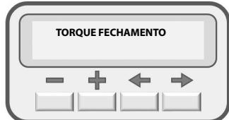
Para aumentar o nível do torque de fechamento pressione e solte GRV (+) e para diminuir pressione e solte CMD (-).
