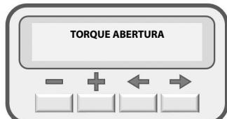
Para aumentar o nível do torque de abertura pressione e solte GRV (+) e para diminuir pressione e solte CMD (-).
